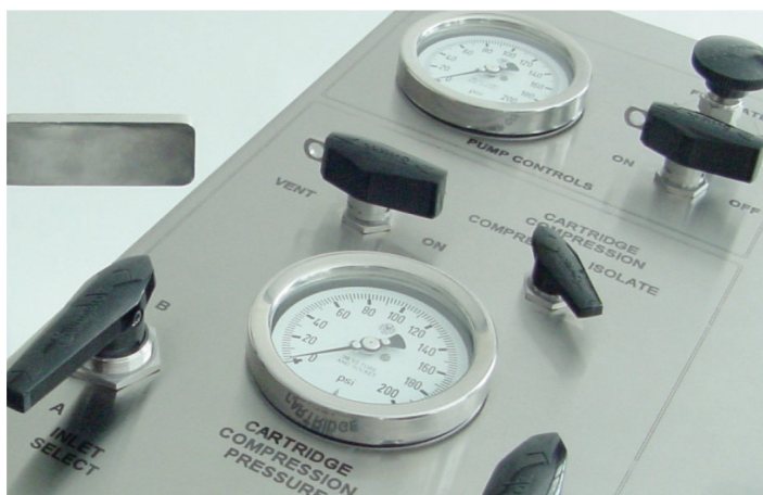
Рис. 18. Панель управления пневматикой, находящаяся в верхней части корпуса флэш-системы, делает эксплуатацию простой задачей. Панель разделена на три секции, которые позволяют пользователям управлять насосной системой. Гидравлический подъемник используется для отвода узла головки, вставки картриджа
