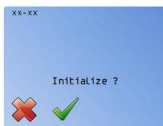
Нажатие клавиши ✗ возвращает в предыдущее меню. Нажатие клавиши ✓ запускает процесс инициализации и подготовки анализатора к новому анализу.
