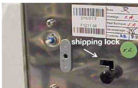
Рисунок 3-3: Замок отделения проб, необходимый при транспортировке
